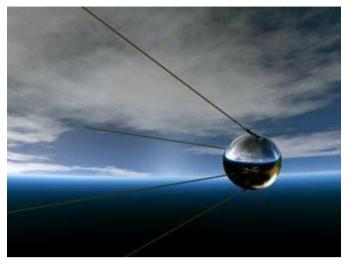
Первый советский искусственный спутник Земли - первый спутник Земли, созданный руками человека; запущен 4.10.1957 г. в 22 ч 28 мин по московскому времени и выведен на орбиту с параметрами: высота в перигее 228 км. высота в апогее 947 км. наклонение 65,1°; период обращения 96.17 мин. Масса спутника 83.6 кг. корпус - сфера диаметром 580 мм, на котором установлены четыре антенны длиной 2,4 м и 2,9 м. Внутри герметического корпуса были размещены: блок электрохимических
